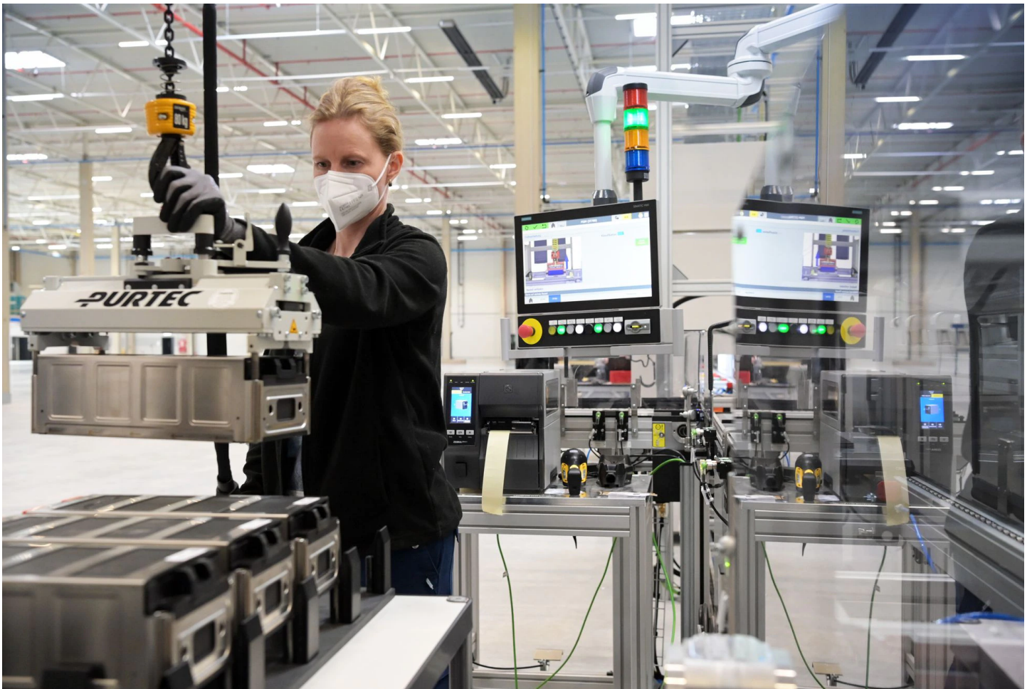
Montaje de baterías en una fábrica del Estado alemán de Brandeburgo. PICTURE ALLIANCE (DPA/PICTURE ALLIANCE VIA GETTY I)
